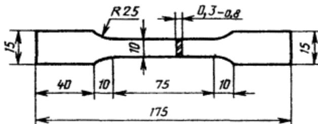
Для испытания на растяжение от каждого контролируемого листа вырезают один образец поперек направления прокатки.
